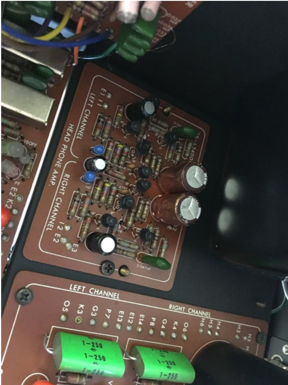
ヘッドホン用のコンデンサー交換（銅巻き）
